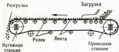
Рис. 7. Схема ленточного конвейера
